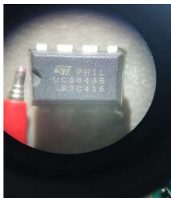
7-нји surat. Вид микросхемы UC3843 в корпусе DIP8 под микроскопом.
