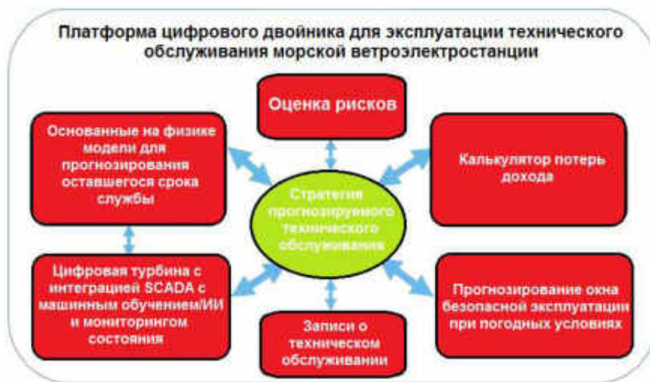
Рисунок 3 – Простая принципиальная схема архитектуры ЦД для виртуальной стационарной и плавучей ВЭС NREL мощностью 5 МВт О&М
