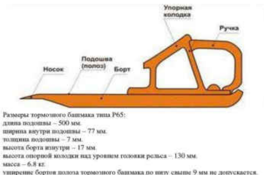
Рисунок 1. Устройство тормозного башмака.
