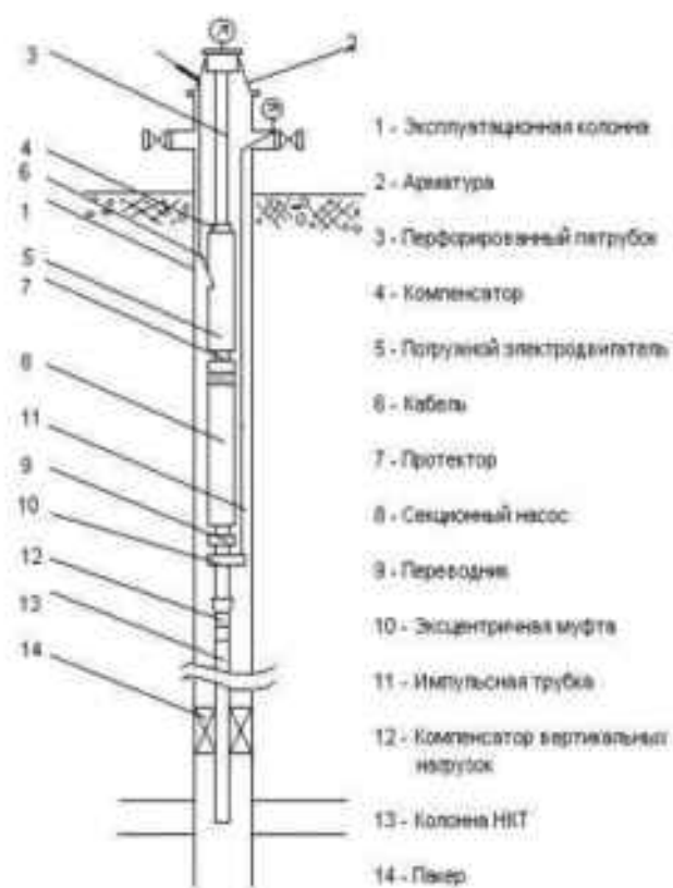
Рисунок 1 – Принципиальная схема компоновки оборудования нагнетательной скважины
